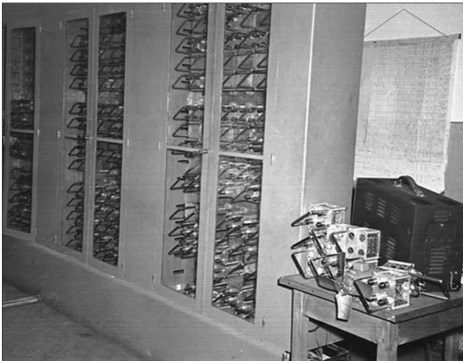
Одна из трех стоек машины ГИФТИ. Справа – типовые блоки.
