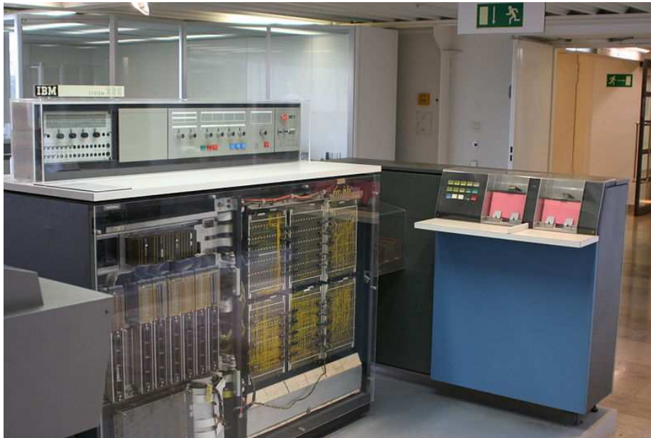
IBM System/360-20 — младшая модель серии (ноябрь 1964). Справа на фото — устройство подготовки данных на перфокартах MFCM (фото из «Википедии», автор Ben Franske)
