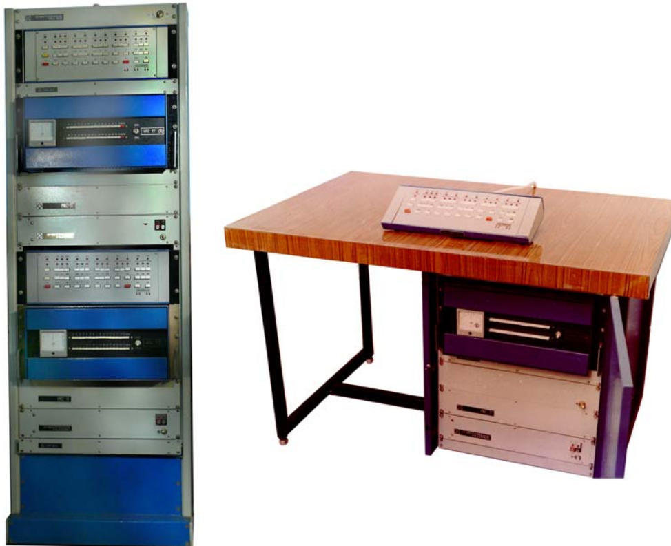
Стойка МКТК «Электроника НЦ-32» и его абонентский пункт
