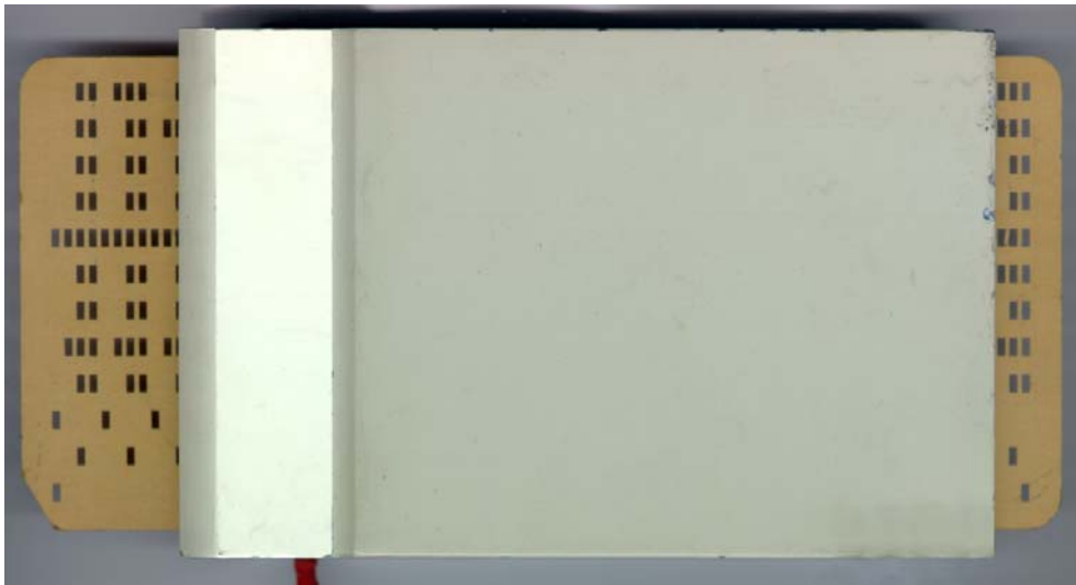
Ручное устройство ввода информации с перфокарты
