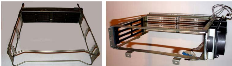
«Корзинки» Электроники-60 и ДВК (справа)
