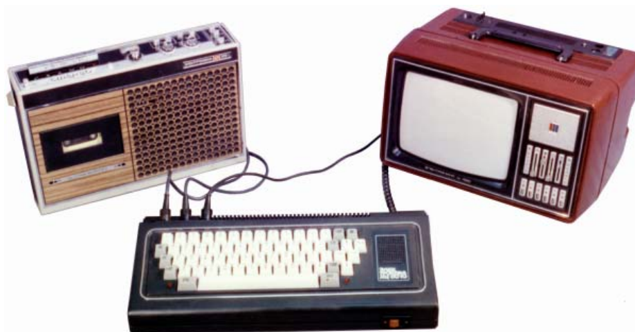
Экспериментальный персональный компьютер «Электроника НЦ-8010»
