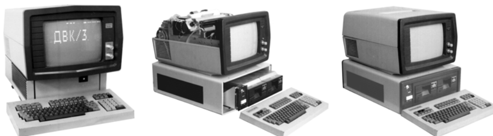
Варианты унифицированного моноблока ДВК-3 и ДВК-4 (в центре — с встроенным сверху принтером)
