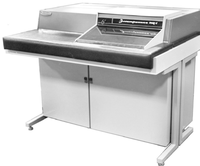
Мини-ЭВМ «Электроника НЦ-1» в компоновке автономного стола
