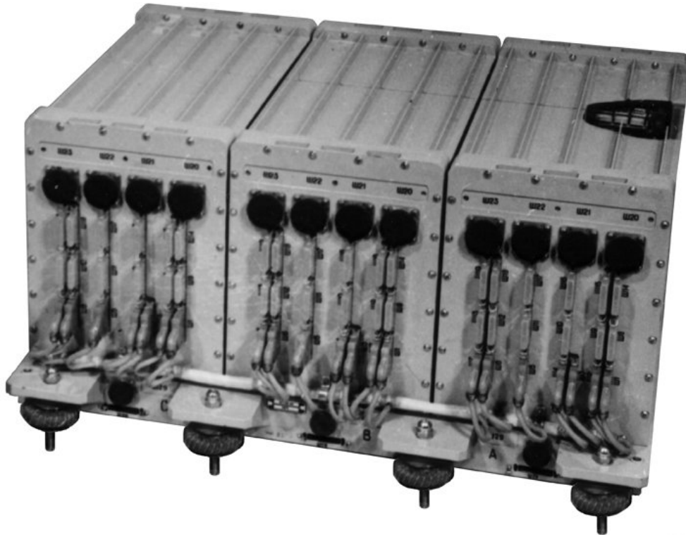
Трехканальная БЦВМ «Салют-3М» для ракетно-космических систем
