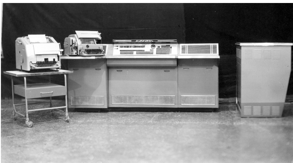
Базовая модель ЭВМ «Наири», освоена в 1964 году. Средства ввода и вывода — телеграфные аппараты РТА50-2М и СТА-2М. Скорость ввода и вывода — 6–8 знак/с
