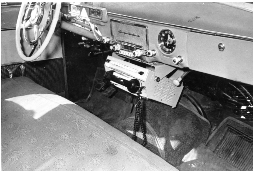
Установка пульта системы «Алтай» в кабине «Волги»
