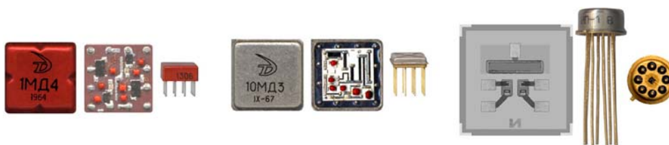
Первые зеленоградские микросхемы: толстопленочные ГИС «Тропа», тонкопленочные ГИС «Посол» и полупроводниковые ИС «Иртыш»
