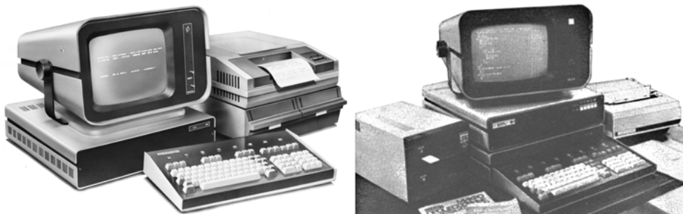
ДВК-2 с 8-дюймовым НГМД и термопринтером и ДВК-2М с 5-дюймовым НГМД и матричным принтером. Производство МЭП
