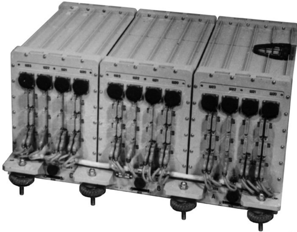
Трехканальная БЦВМ «Салют-3М» для ракетно-космических систем
