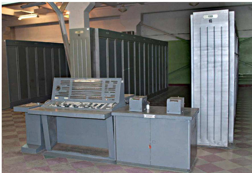
Общий вид ЭВМ К340А: 20 шкафов в три ряда и инженерный пульт
