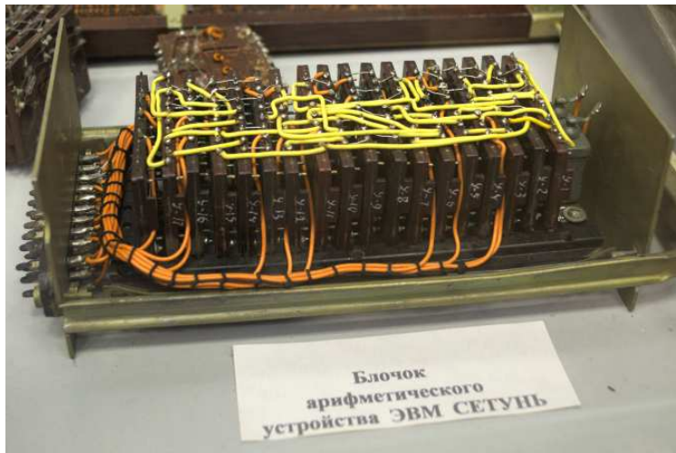
Блок феррит-диодных элементов ЭВМ «Сетунь»
